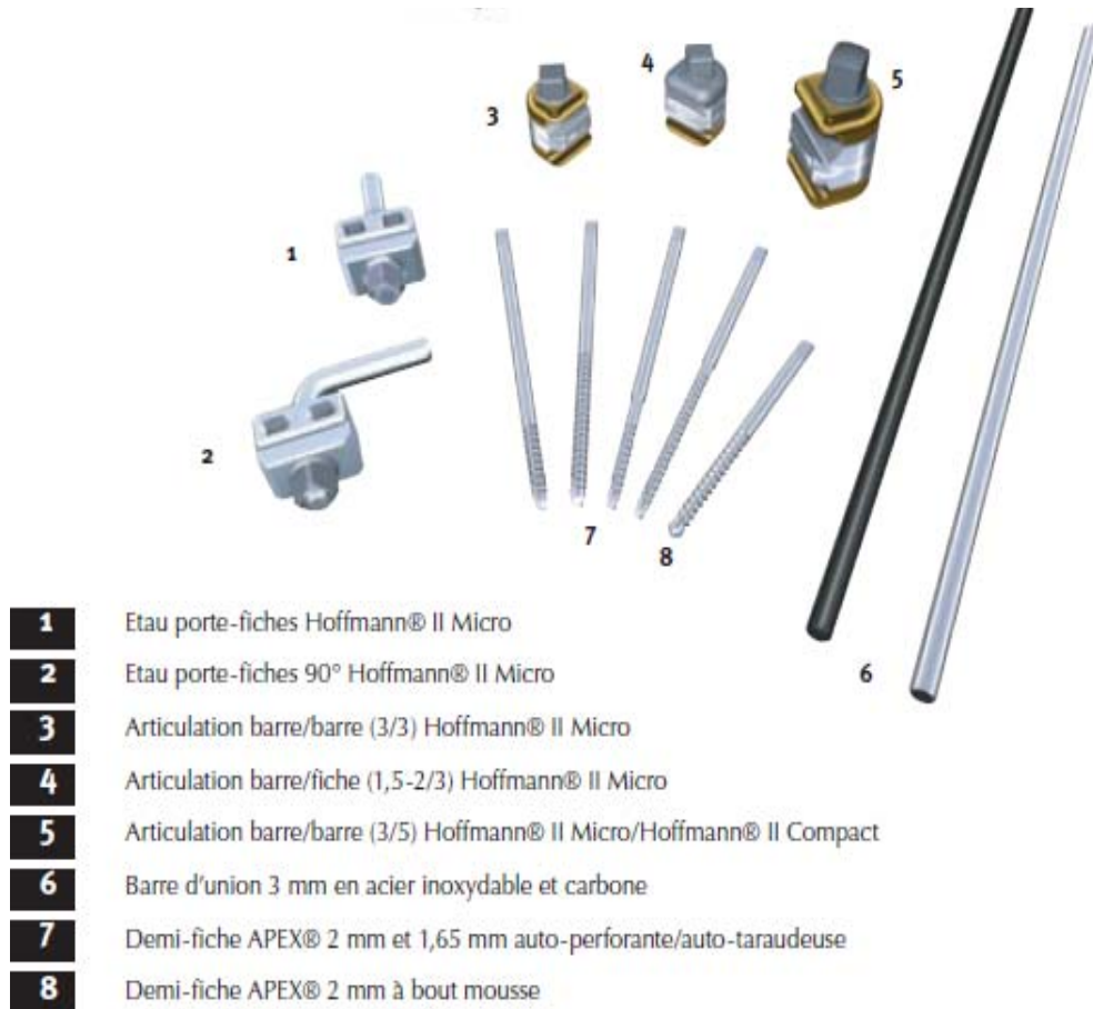
Fig45 : le matériel du fixateur Hoffmann II [45]
