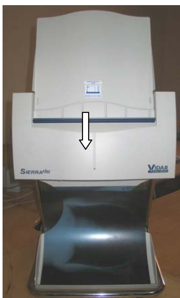
Fig.6 : Le cliché passe au scan puis on le récupère sur le trépied en bas
