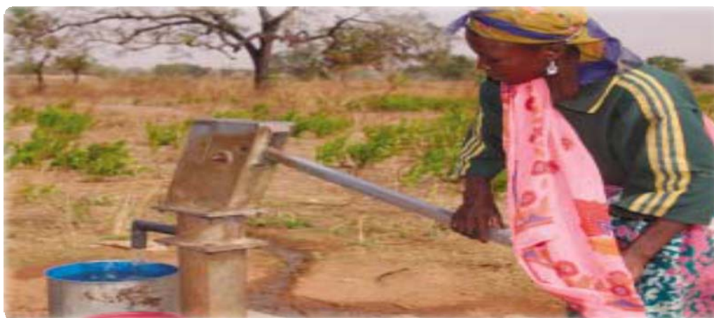
Fig 4 :Approvisionnement en eau à partir d'un forage muni d'une pompe à motricité humaine
