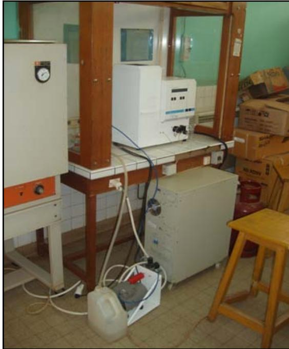
**Figure 10 : Photomètre de flamme à dilution automatique**
