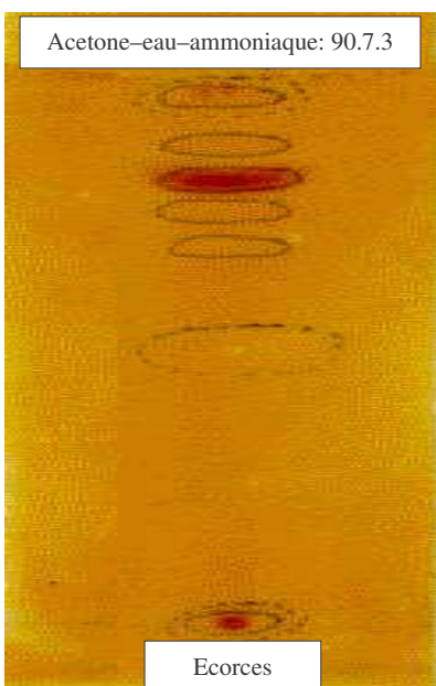
Figure 20 : Chromatographie sur couche mince des alcaloïdes totaux de Hallea ciliata dans le système acétone – eau – ammoniacque (90-7-3)
