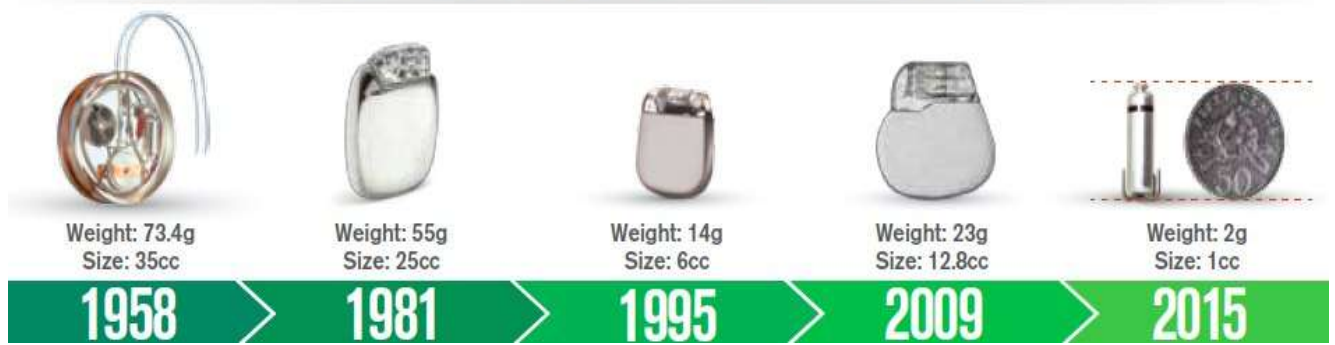
Figure 9 : évolution des boîtiers de pacemaker. [10]
