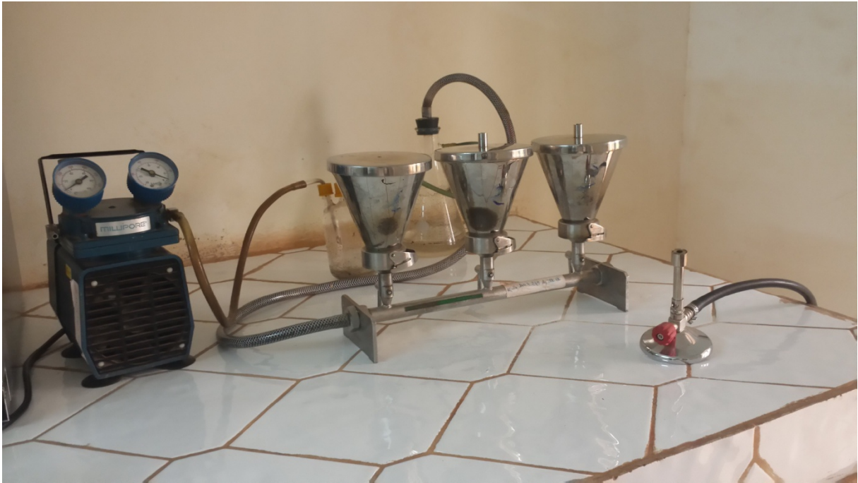
Photo 4: rampe de filtration.
