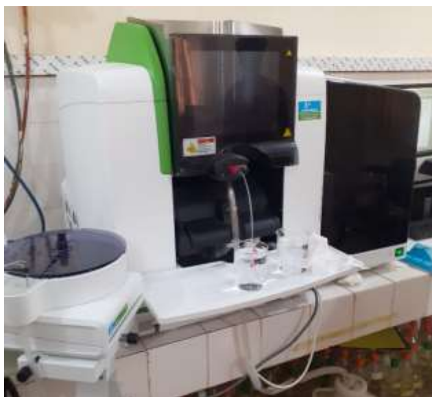
- Photo 8 : Spectrophotomètre d'Absorption Atomique Perkin Elmer PinAAcle 900T
