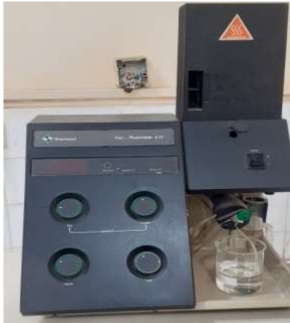
Photo 1 : Spectromètre à flamme 410
