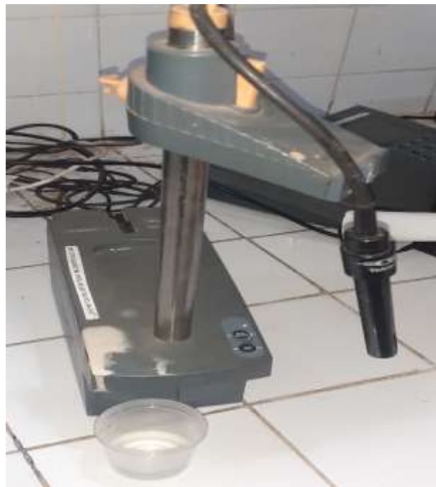
Photo 4 : Multi-paramètre INOLAB pH 740
