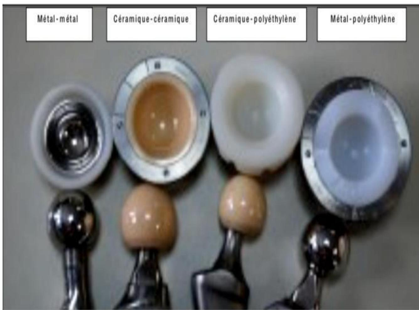
Figure 22: différents types de couples de frottement
