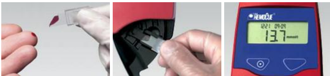
Figure 19. Mécanisme de mesure du taux d'Hb par l'appareil HemoCue ® 201+ Le résultat est exprimé en gramme d'hémoglobine par décilitre de sang (g/dl)
