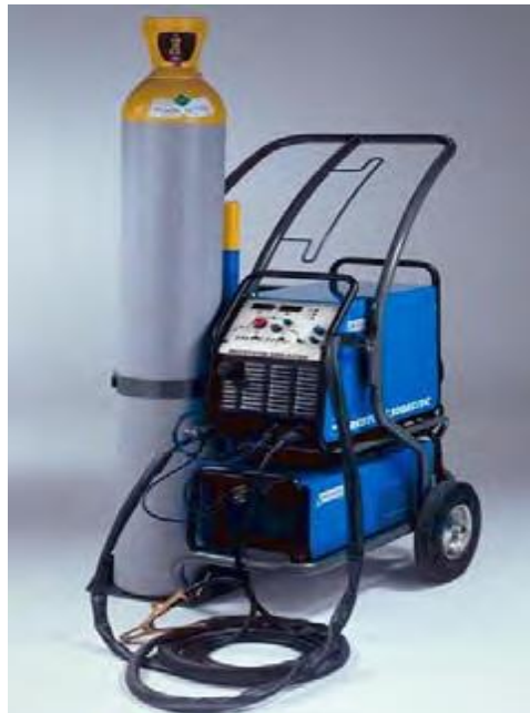
Figure 3 : Matériels de soudage à l'arc sous protection gazeuse.
