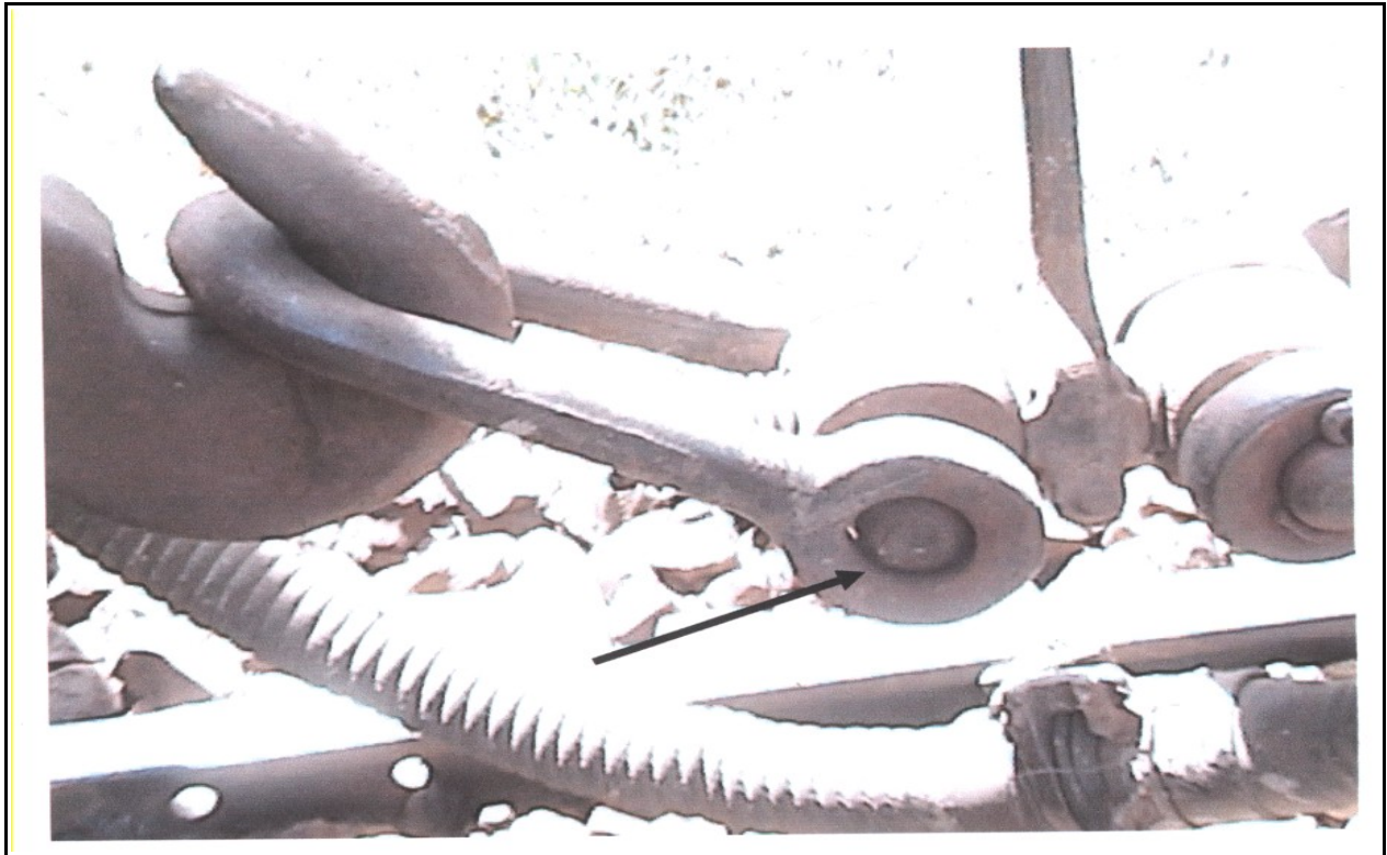
Wagon N°2440586, manque de goupille à l'attache en U, danger de rupture de train.
