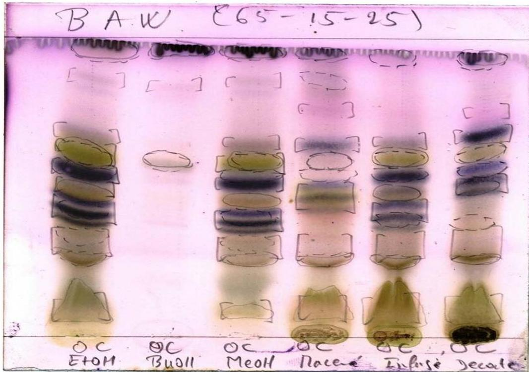
**Figure n°23: Chromatogramme des extraits aqueux et alcooliques révélé par le Mélange Anisaldehyde**
