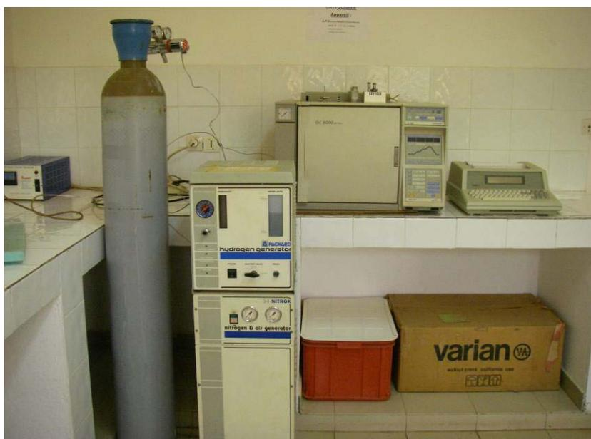
**Figure n°19 : Photo du chromatographe en phase gazeuse**
