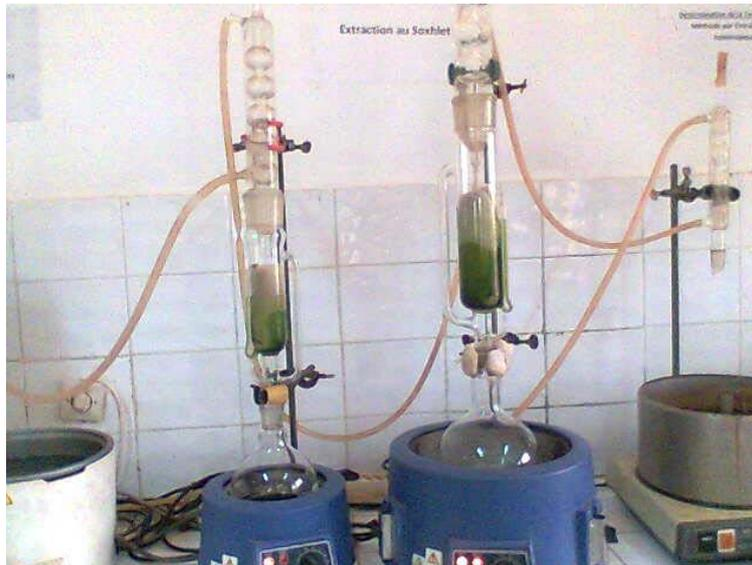
Figure n°11 : Photo du dispositif de l'extraction au Soxhlet
