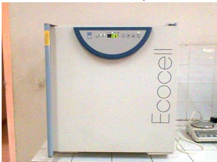
**Figure n°6 : Photo de l'étuve et de la balance de précision**
