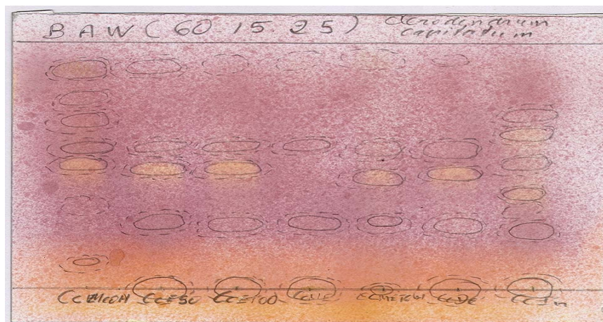
Figure N°25 : Chromatogramme présentant les résultats du test antioxydant (DPPH) réalisé sur les extraits polaires de Clerodendrum capitatum .
