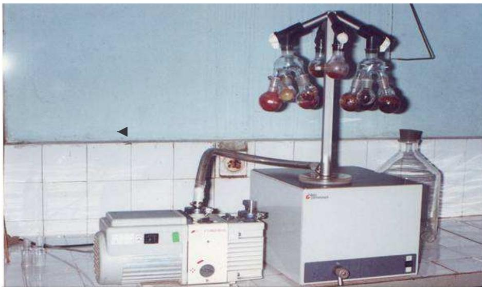
**Figure 2** : Photo du lyophilisateur utilisé pour sécher les extraits aqueux de de *M. crassifolia*
