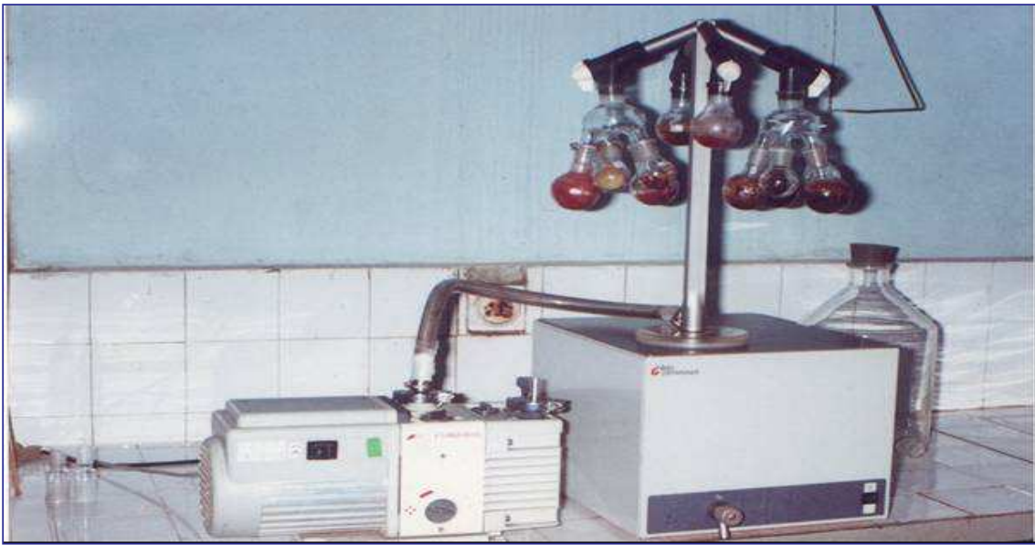
Figure n°9: Photo du Lyophilisateur utilisé pour sécher les extraits aqueux de Syzygium guineense .
