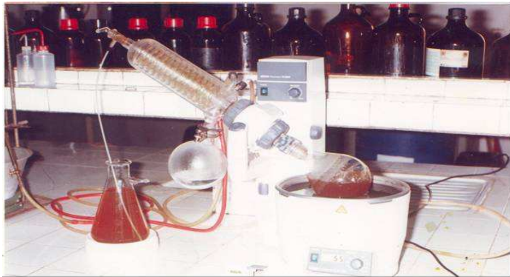
Figure 6: Rotavapor utilisé pour concentrer nos extraits aqueux, éthanoliques et méthanoliques de M. angolensis
