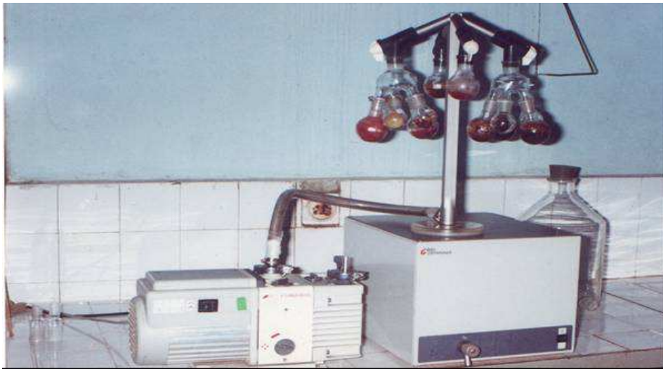
Figure 7: Lyophilisateur utilisé pour séché les extraits aqueux, éthanoliques et méthanoliques du Maerua angolensis .
