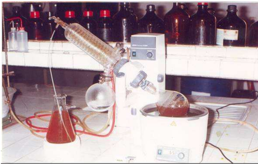
Figure n°8: ROTAVAPOR UTILISE POUR CONCENTRER LES EXTRAITS DE Combretum glutinosum
