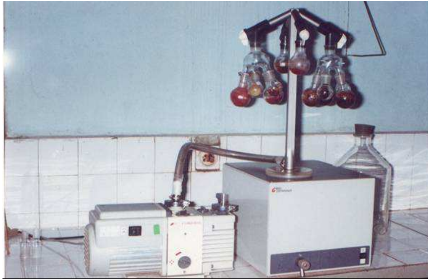
Figure n°7: LYOPHILISATEUR UTILISE POUR SECHER LES EXTRAITS POLAIRES DE Combretum. glutinosum
