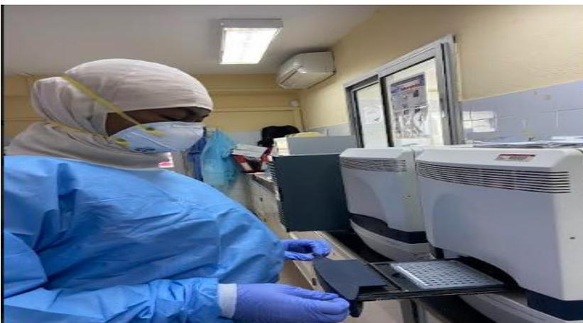
**Figure 18:** Insertion de la plaque dans la machine AB7500 Fast pour la détection du virus SRAS-COV-2 dans le laboratoire de Biologie Moléculaire et de Génomique
