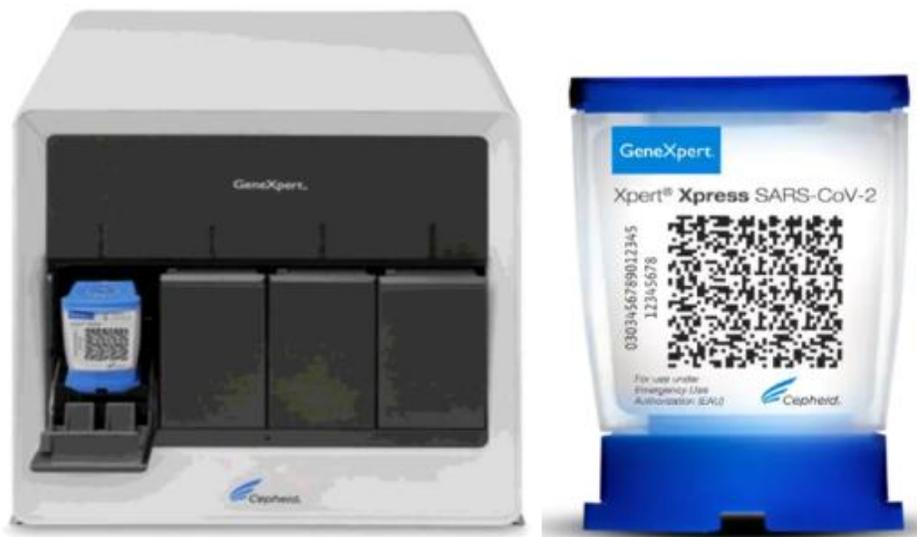
**Figure 11:** Equipement du test de Xpert® Xpress SARS-CoV-2
