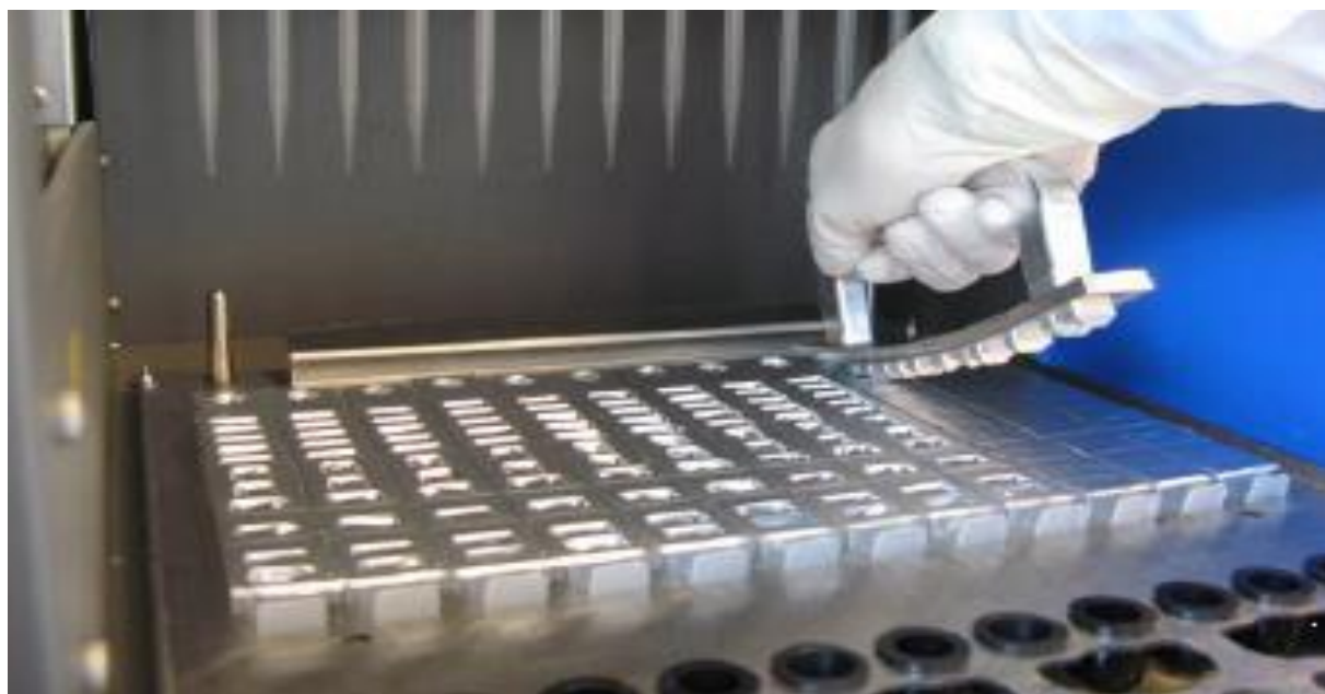
Figure 61: Percer franchement les puits.
