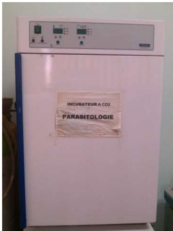
Figure 12 : Incubateur à CO 2 (VWR, Série 1001 502, Modèle 2325_2)
