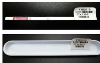
La bandelette doit être placée dans le bac de travail avant l'ajout de l'échantillon.
