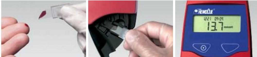
Figure 4: Mécanisme de mesure du taux d'Hb par l'appareil HemoCue 301+
