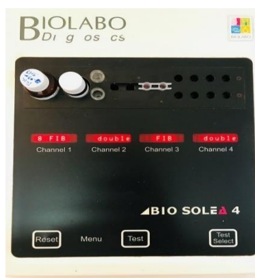
Figure 16: Le semi-automate d'hémostase (coagulation) BIOLAB SOLEA v4 pour le dosage du fibrinogène, (source : laboratoire de l'hôpital du Mali).
