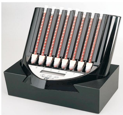
Figure 17: Technique de dosage de la vitesse de sédimentation (SEDIMAT™ 15 PLUS), (source : internet).
