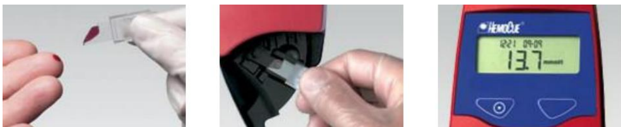
Figure 10 : Mécanisme de mesure du taux d'Hb par l'appareil HemoCue 201+ Le résultat est exprimé en gramme d'hémoglobine par décilitre de sang (g/dl)
