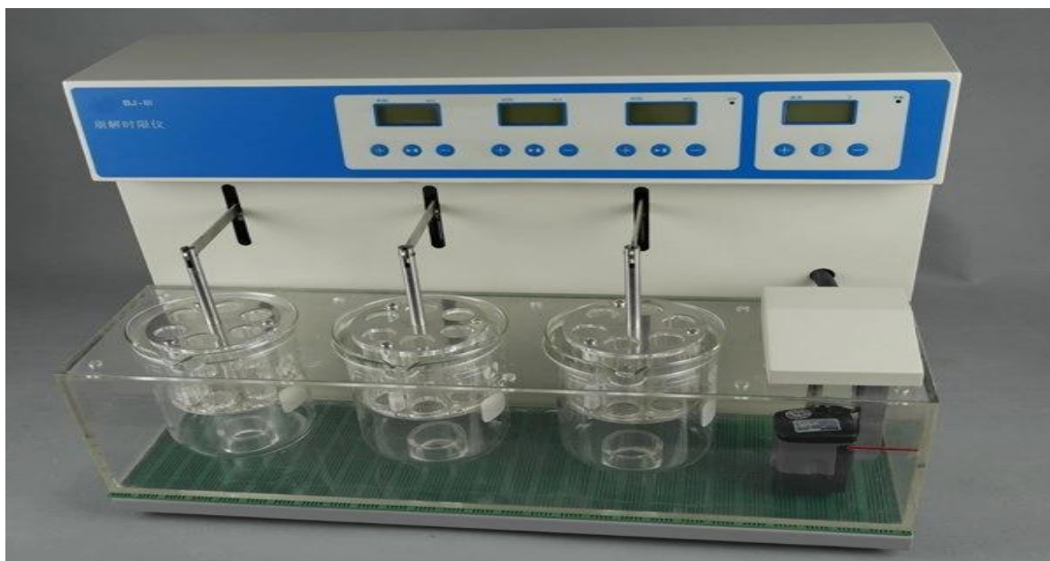
Figure 3 : Appareil de test de désagrégation
