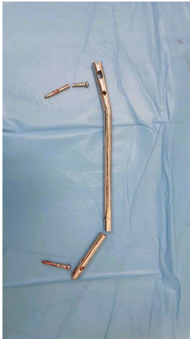
Rupture d'un clou tibial (image du service)
