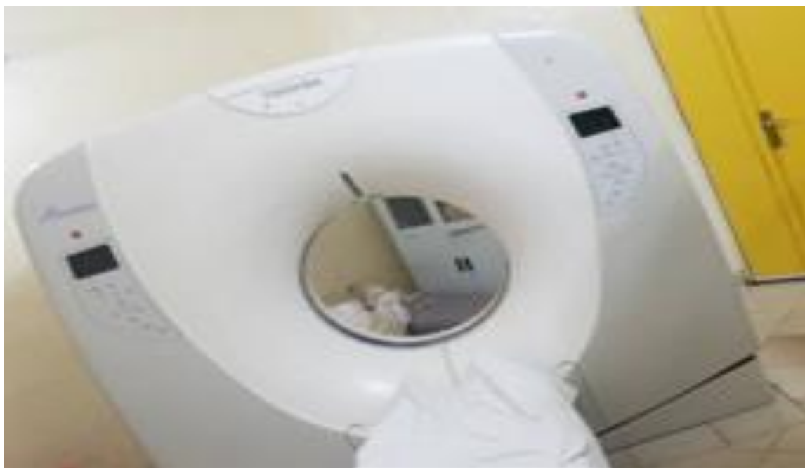
Figure 9 : Image du scanner de marque THOSIBA muni de 16 barrettes.
