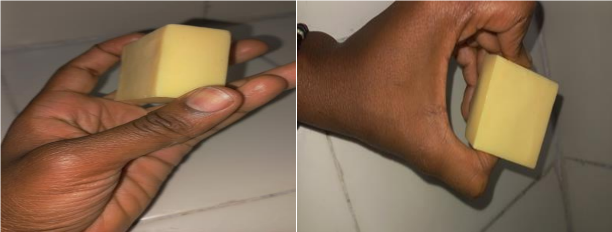
Figure 27 : Echantillon 2 (aucune déformation)
