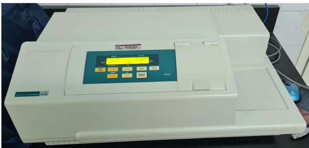
**Figure 16:** Spectrophotomètre (SpectraMax Plus 384) utilisé pour cette étude.
