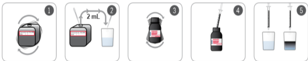
Figure 13 : Technique de test avec le réactif WATA Test
