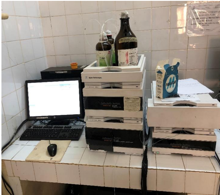
Figure 7 : Chromatographe en phase liquide à haute performance associé à un DAD Un appareil utilisé dans la séparation analytique et/ou préparatrice de molécules polaire, thermolabile présentent dans un mélange. Le détecteur à barrette de diode permet d'améliorer la sensibilité de détection
