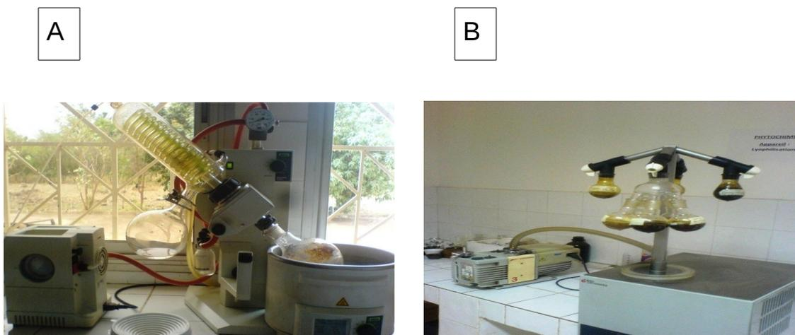
**Fig. 23 :** Rovavapor (A) et lyophilisateur (B) utilisés respectivement pour concentrer et lyophiliser nos extraits.
