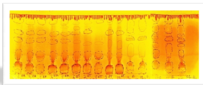
Figure N°15 : Chromatogramme des extraits aqueux et hydroéthanoliques après migration dans du BAW (Butanol – Acide acétique – Eau) dans les proportions (60 : 15 : 25) et révélation par le Dragendorff.
